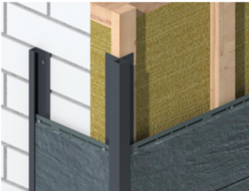
Exemple de finition lorsqu'on isole qu'une partie de mur peut être transposée au traitement des ébrasement de baies
